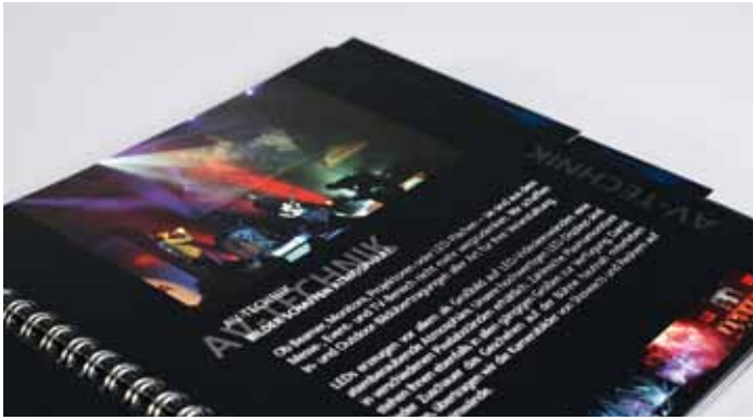
Imagebroschüre für Eventplanung und -technik, Druck Euroskala, Sonderfarbe und Dispersionslack mit partiellem Siebdruck UV-Lack, Registerstanzung, Zusammentragen und Spiralbindung.
